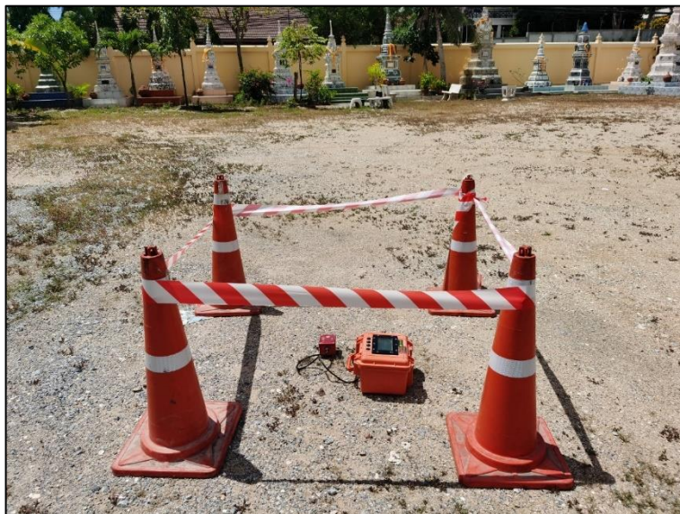
รูปที่ 4.3.3-2 แสดงการตรวจวัดความสั่นสะเทือน (บริเวณวัดนาจอมเทียน)
